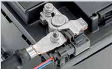
Montage am Standard-Batterie-Pol
